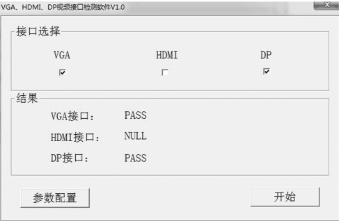
图 11 VGA、DP 接口检测通过
